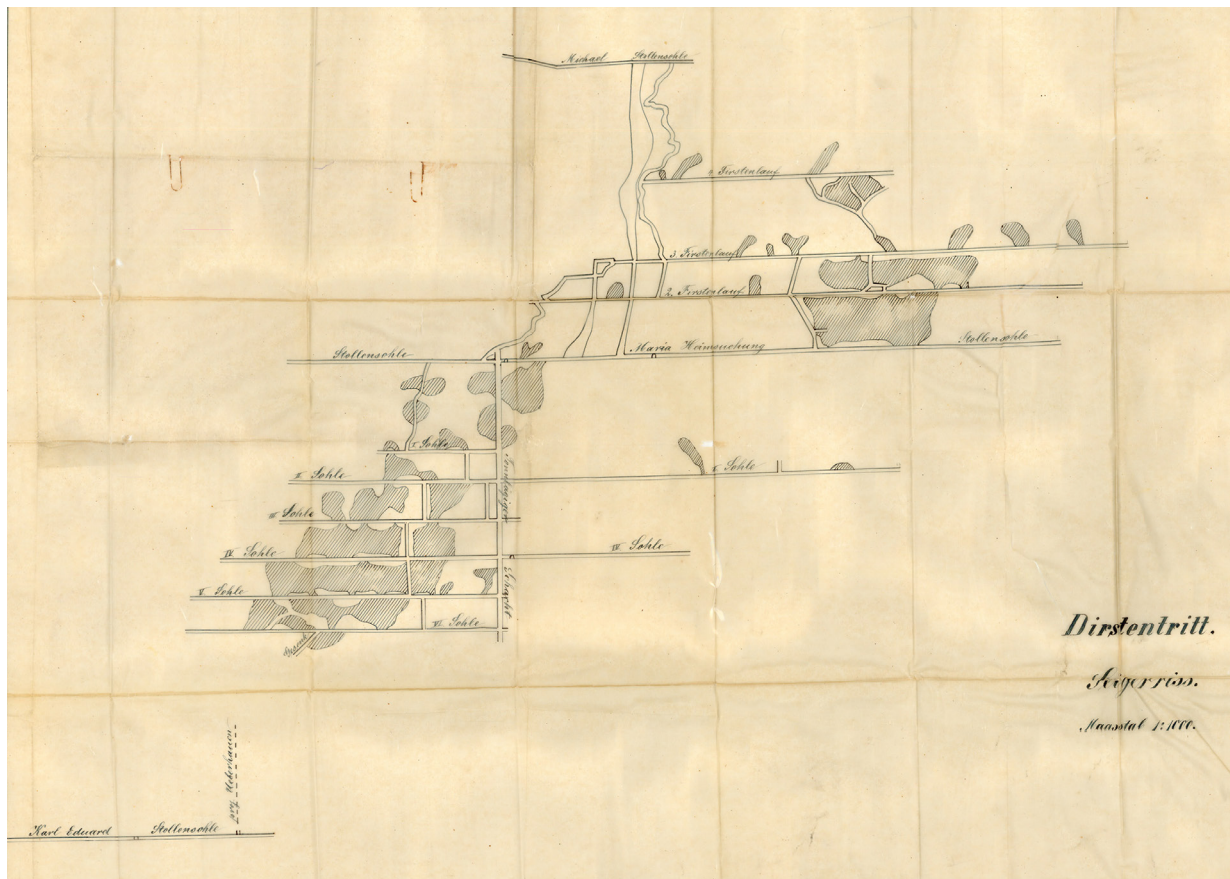
Abb. 7: Seigerriss der Grube Dirstentritt von Ende 1917 (Bundesarchiv Berlin Sign. R8737/286 Blatt 34).
